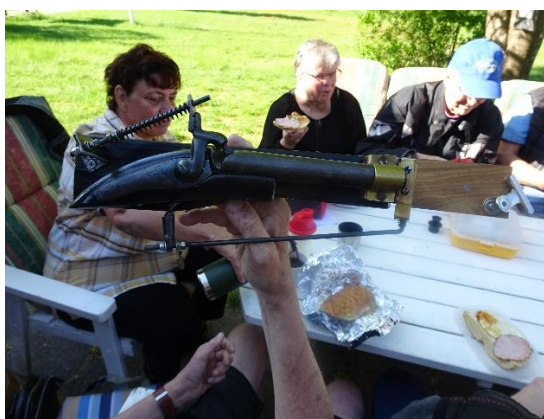
Rolf Johanssons bidrag till frågesporten (utom tävlan). Det är en egenhändigt tillverkad musfälla där en ostbit sätts fast i klämman framför pipmynningen, den hungriga musens vikt utlöser därmed avtryckaren och musen förpassas till en fridfullare värld...
